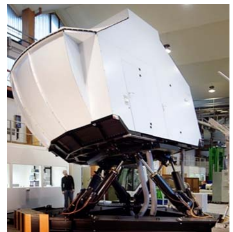
Abb. 6: Interaktiver Forschungs- und Entwicklungssimulator für Bau- und mobile Arbeitsmaschinen am Lehrstuhl für Baumaschinen und Fördertechnik der TU Dresden (Prof. Kunze)
