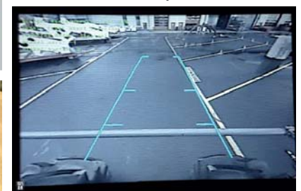
Abb. 14: Rückfahrassistent der Wirtgen GmbH bei Kaltrecyclern WR240/WR240i
